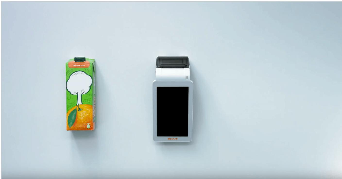
Смарт-терминал состоит из основания, принтера чеков и планшета:
