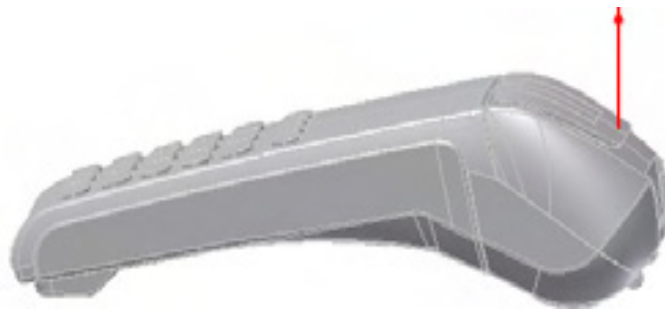
Рис.4 Открытие крышки отсека принтера
